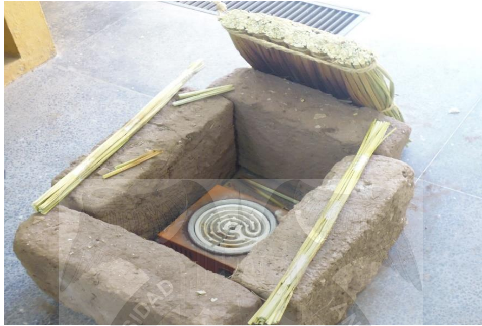
VISTA 05: SE OBSERVA EL COLOCADO DE 04 ADOBES EN FORMA DE CUADRADO Y EN SU INTERIOR UNA COCINA ELECTRICA
