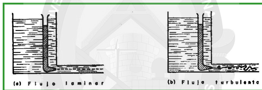
FIGURA 1 DISTINCIÓN EXPERIMENTAL OBJETIVA ENTRE EL FLUJO LAMINAR Y EL TURBULENTO.
