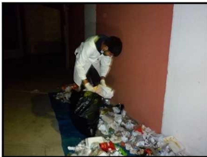
Fotografía 12. Colocación de la parte seleccionada por el cuarteo en distintas bolsas dependiendo del tipo de Residuo Sólido
