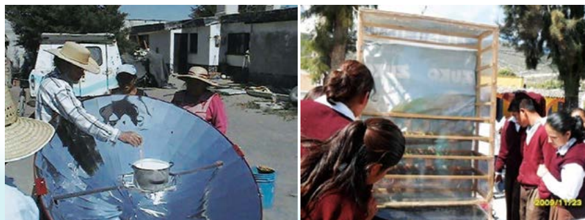
Figura 4. Utilización de hornos solares para la preparación de alimentos y deshidratadora de frutas y hortalizas.
