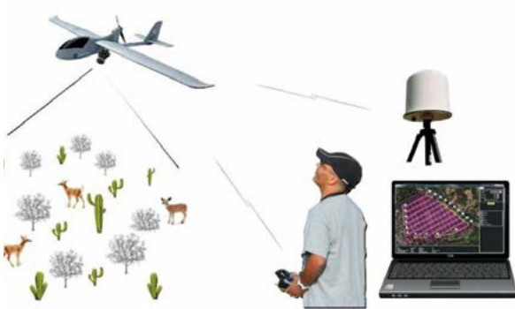
Esquema de operación del sistema: Firstar V2, computadora recibiendo telemetría y enviando definición de la ruta, antena, piloto y zona de estudio
