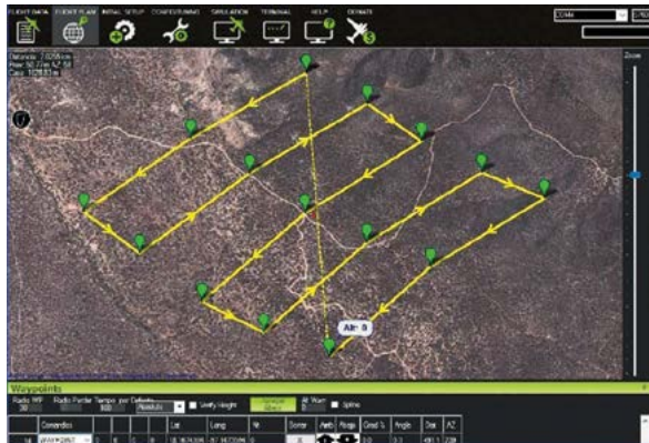
Programación del piloto automático en Mission Planner, para el recorrido del UAS (Unmanned Aircraft System)
