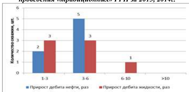
Рис. 2 Распределение прироста дебита нефти, жидкости после проведения ГРП + ГПП, ГРП со сверхлегким пропантом за 2013, 2014 г.
