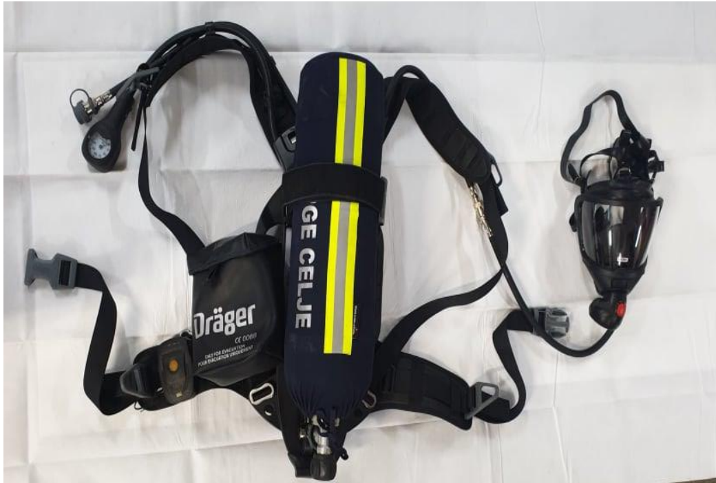
Slika 2.1: Izolirni dihalni aparat (osebni arhiv)
