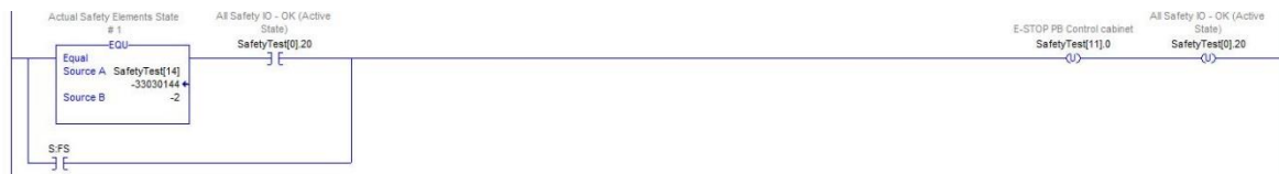
Slika 6.22 PLC1 Program 11: Preverjanje posameznega varnostnega elementa
