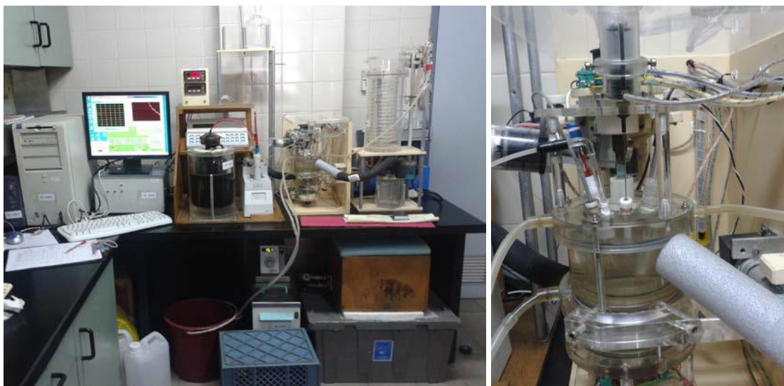
Figura 4: Izquierda: vista general del sistema de titulación potenciométrica en celda cerrada. Derecha: detalle de la celda de titulación. Extraído de Berghoff et al. , (2016).
