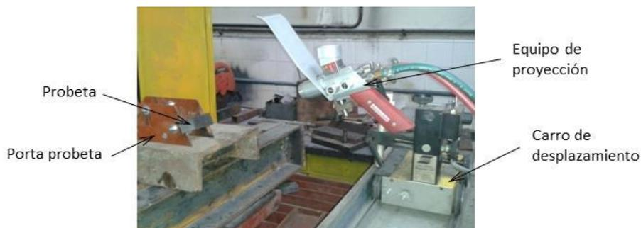
**Figura 1:** Dispositivos y equipos utilizados para la aplicación del recubrimiento.
