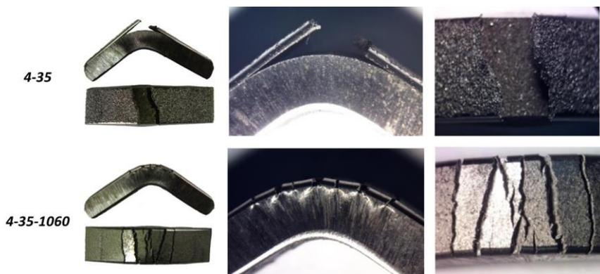
Figura 9: Ensayo de plegado realizado sobre probetas as spray y refundida a 1060°C.
