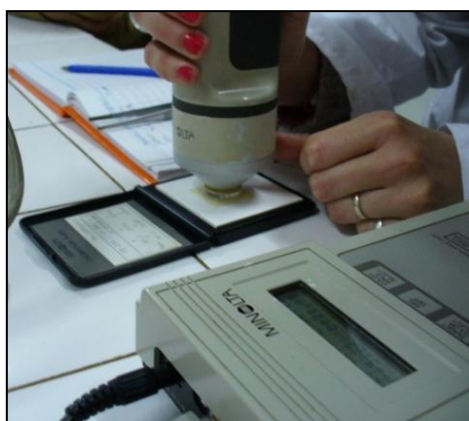
Fig. 2.14: Medición de color de films con colorímetro triestímulo
