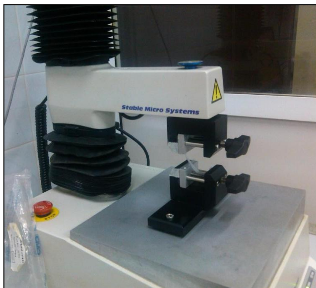
Fig. 2.13: Sistema de mordazas utilizado para los ensayos de resistencia a la tracción de las películas
