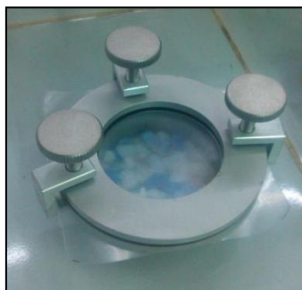
Fig. 2.6: Celdas de permeación utilizadas para determinación de la permeabilidad al vapor de agua de películas
