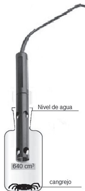
Figura 1. Diagrama de la cámara metabólica cerrada utilizada en los ensayos de consumo de oxígeno, consistente en una botella hermética de vidrio de 640 cm 3 de capacidad con un oxímetro digital acoplado.
