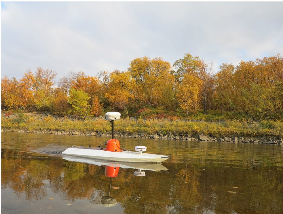
Kuva 38. Virtausnopeuksien ja virtaaman mittausta kauko-ohjattavaan veneeseen integroidulla virtausnopeusmittarilla. Veneen pohjasta suuntautuu alaspäin akustinen pulssi, joka mittaa vedessä olevien partikkelien liikkeeseen perustuen virtausnopeutta. Veneeseen on kytketty myös GPS-paikannin. Kuva: Leena Laamanen. Turun yliopisto, virtavesien tutkimusryhmä.
