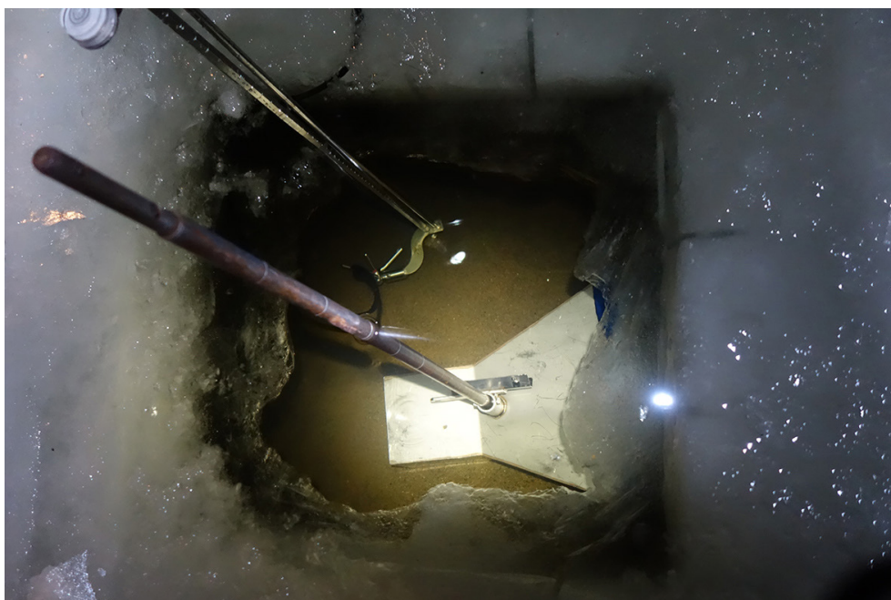
Kuva 36. Talvista jäänalaisen pohjakulkeuman ja virtausnopeuden mittausta hiekkapohjaisessa uomassa. Käytössä on Helley-Smith -tyyppinen pohjakulkeuman mittalaite. Kuva: Eliisa Lotsari. Historian ja Maantieteiden laitos, Itä-Suomen yliopisto.
