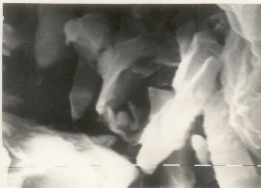
Foto II.4.- Microfotografía electrónica de cristales prismáticos de cuarzo, con formas romboédricas y prismáticas. (SEM, barra= 10 micrones).
