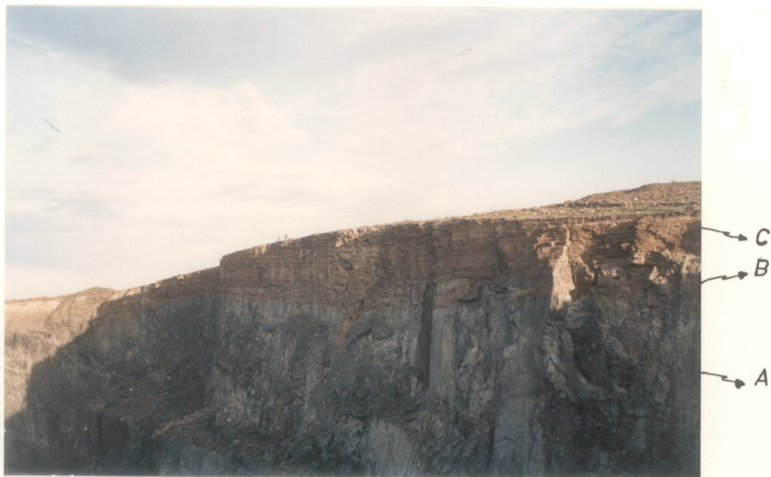
Foto II.1.- Frente de explotación sudoeste de la cantera "Villa Mónica II", vista desde el norte. Se observa el basamento cristalino (A), el nivel de alteración del basamento (B) y la Asociación de Facies Cuarzo-arcólicas (C).
