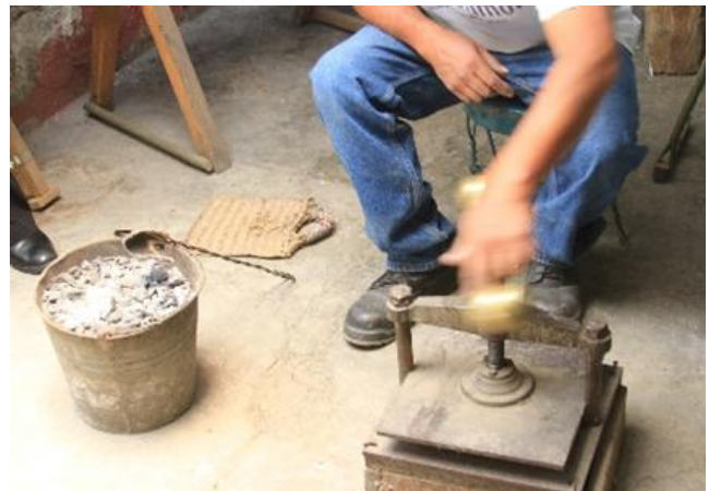
Ilustración 9: Aplanado de Cuerno. Fotografía AAMR.
