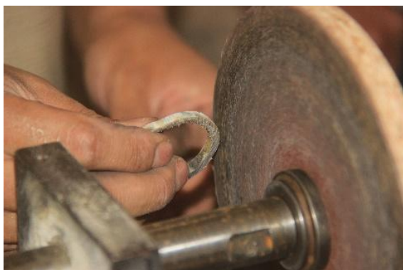
Ilustración 7: Lijado de aros de cuerno Fotografía. AAMR
