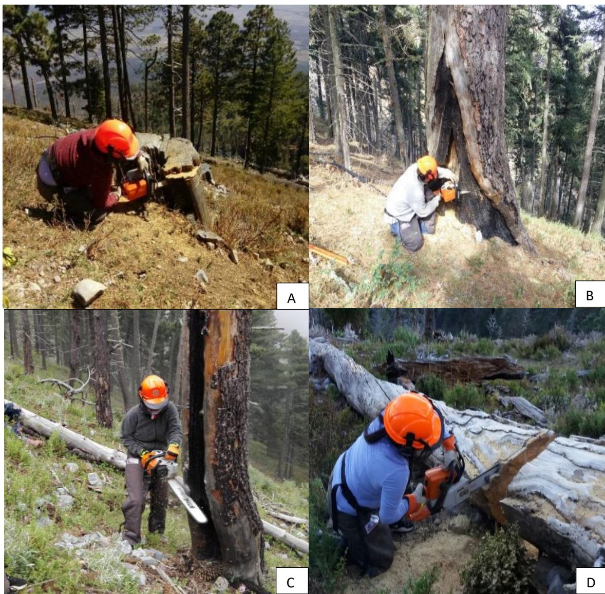
Figura 6. Obtención de muestras en campo con evidencia de incendios: A) tocón, B) árbol vivo, C) árbol muerto en pie y D) árbol muerto caído.
