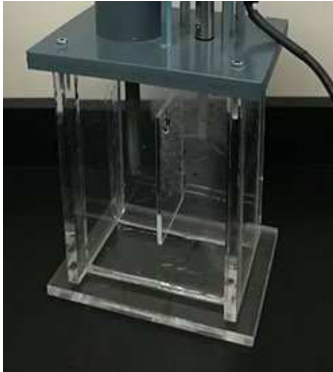
Figura 125. Tanque de temple (construido en acrílico transparente)
