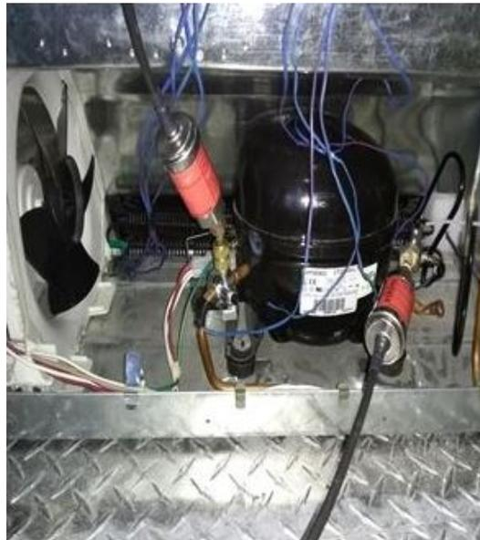
Figura 4.17: Sensores de presión en la succión y descarga del compresor.
