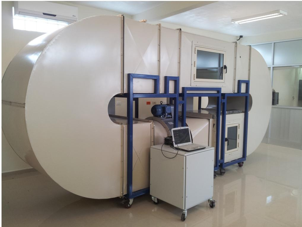
Figura 4.2: Calorímetro tipo túnel de viento.
