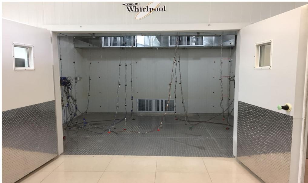
Figura 3.1: Distribución de los termopares en la cámara de ambiente controlado.
