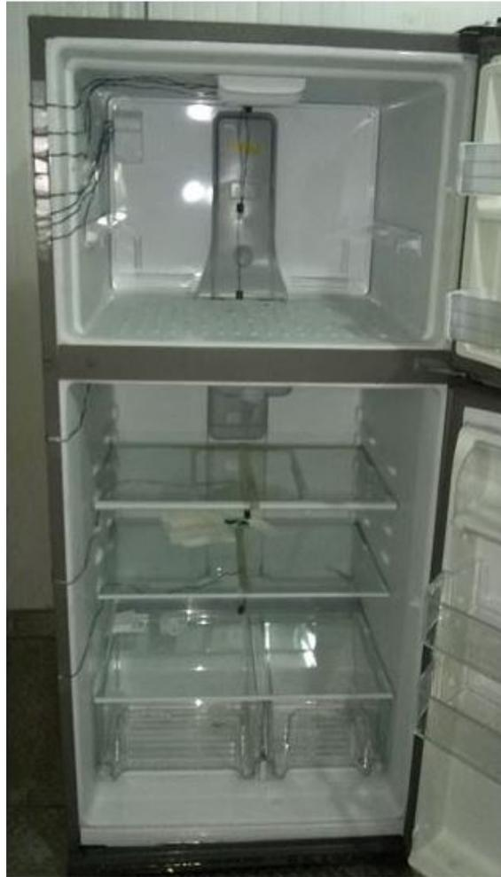
Figura 4.18: Instrumentación del refrigerador de prueba.
