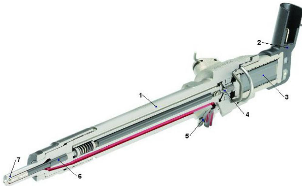
Figura 2.2: Vista interna del inyector piezoeléctrico.
