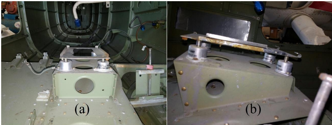
Figura 1.1. Montaje de aislantes de vibración, bajo el soporte para tarjetas electrónicas de la aviónica, en el interior de una aeronave de ala fija tipo Cessna: (a) vista frontal hacia la parte trasera del fuselaje y (b) vista lateral del montaje.
