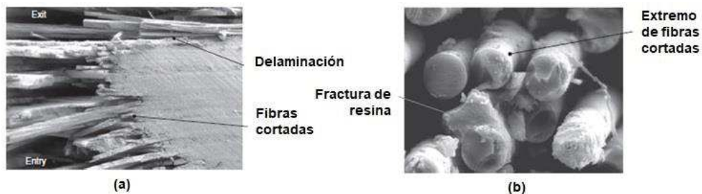
Figura 23. Micrografía electrónica de una sección de un laminado CFRP sometido a impacto balístico, (a) 40X,y (b) extremo de las fibras 9000X [49]
