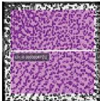
Figura 34. Mediciones realizadas mediante análisis DIC . La línea intermedia blanca es L0 y el cuadro morado representa el área global.
