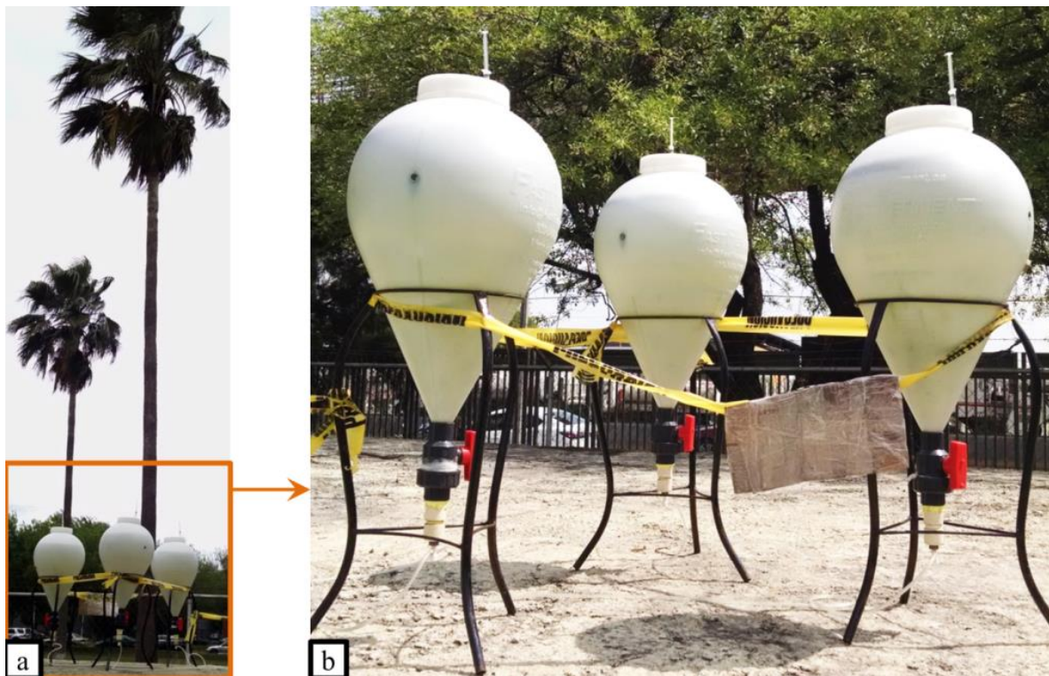
Figura 4.5.- Cultivo de consorcios de microalgas en ESPTAR. a) Vista panorámica del sistema de cultivo. b) Conjunto de reactores fast ferment
