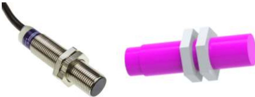
Figura 42: Sensor capacitiu de proximitat i representació 3D
