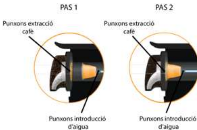
Figura 27: Funcionament en càpsules Nespresso
