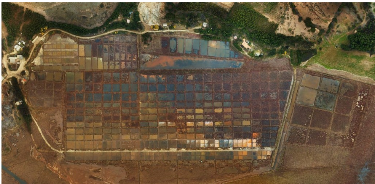
Fig. 06 Ortofoto de Salinas de Lobos y San Rafael, Puchuncaví. Obtenida mediante captura de datos con dron y procesado con programa informático Agisoft photoscan, 2018. Fuente: Elaboración propia
