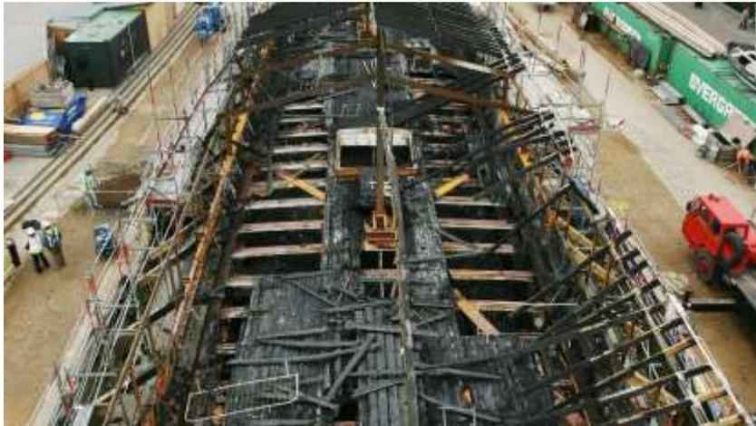
**Figura 98.** Daños causados en el Cutty Sark por el incendio sucedido en el año 2007
