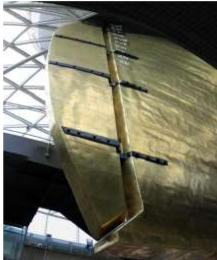
**Figura 113.** Timón con revestimiento de planchas del metal Muntz del clíper Cutty Sark
