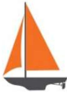
**Figura 128.** Velero con aparejo *sloop* fraccionado
