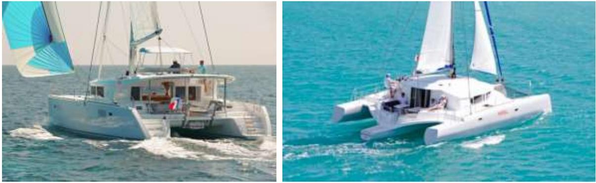
**Figura 119.** Ejemplos de un catamarán (izquierda) y un trimarán (derecha)
