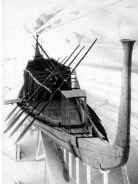
**Figura 10.** Disposición de los remos, cabinas y pasarela de la barca de Keops
