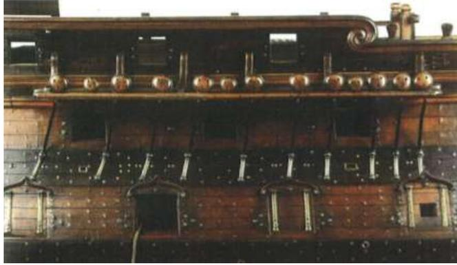
**Figura 78.** Detalle de una de las mesas de guarnición del navío de línea San Francisco de Asís de 70 cañones
