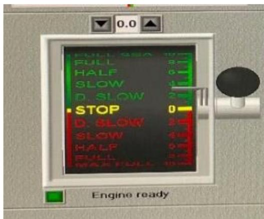
Figura 23: Controles del motor principal del buque. Fuente: Elaboración propia.
