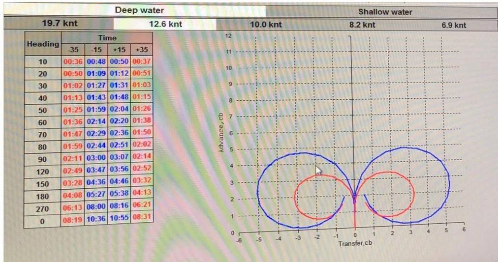
Figura 11: *Turning Circles / Deep water*. Fuente: Elaboración propia.
