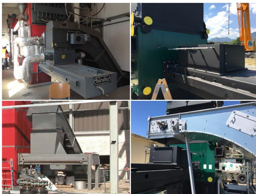
Imagen 5.2.1.1.2. Conjunto de fotografías de empujadores hidráulicos
