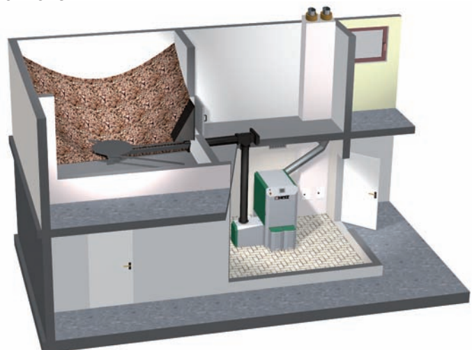
Armazém e área de aquecimento em níveis diferentes. Transporte horizontal com mecanismo rotativo por mola e tubo de queda.
