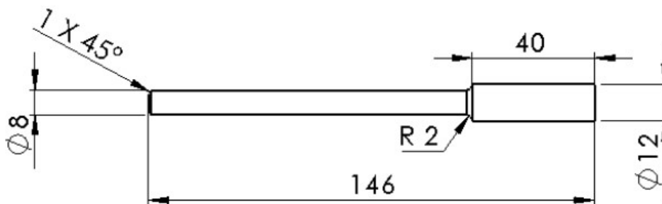
Figura 6.5. Dimensiones de las probetas para el ensayo de fatiga.
