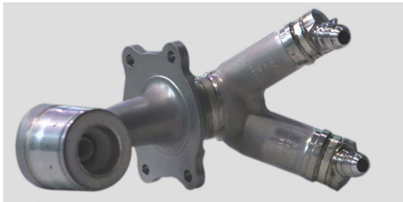
Figura 2.5. Conducto deflector de combustible para turbinas de gas impreso por SLS. Fuente: www.3printr.com
