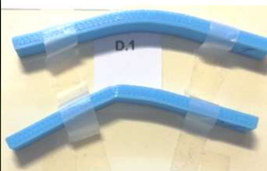
Figura 5.8. Fotografía de probeta con orientación X, fallo por laminación. Probeta D_1, D_2.
