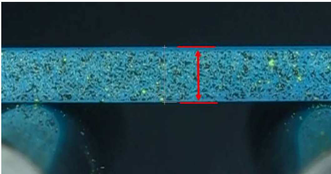
Figura 3.24. Medición de la resolución. Grosor de la probeta: 3,95 mm. Nº píxeles; 111. Ratio: 27,75 mm/píxel.
