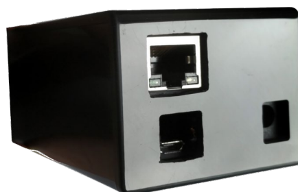
Ilustración 12. WEMOS D1 R1 con módulo Ethernet y caja DesignSpark. Fuente propia, Abril 2019.
