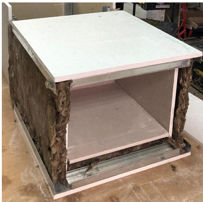
Figura 71: Incorporació de la llana de roca a l'estructura lateral. Font: Pròpia
