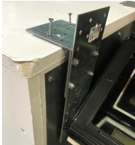
Figura 23: Sistema per fixar el mòdul WETWALL a la caixa de mesures. Font: Pròpia
