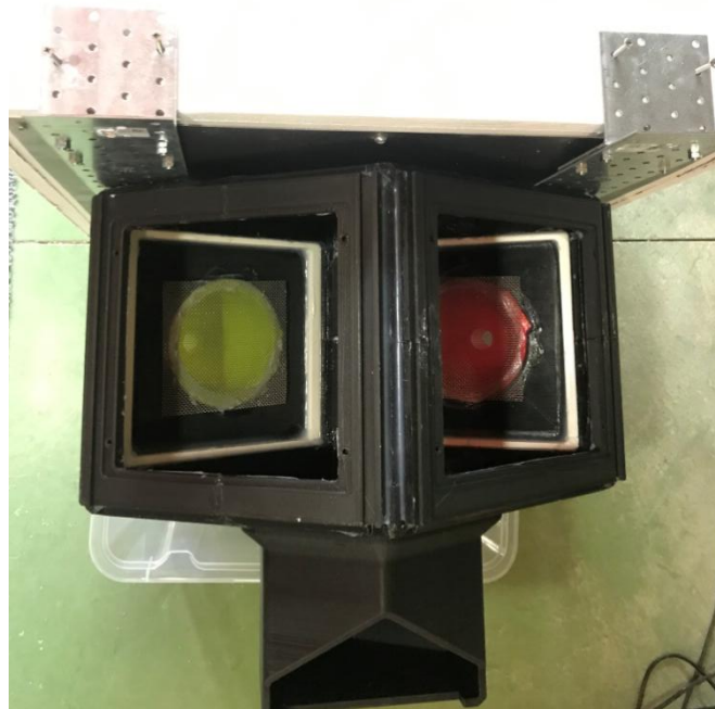
Figura 22: Mòdul muntat i fixat a la caixa de mesures. Font: Pròpia
