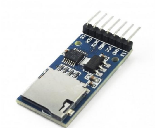
Figura 51: Imatge del mòdul MicroSD. Font: Naylampmechatronics.com
