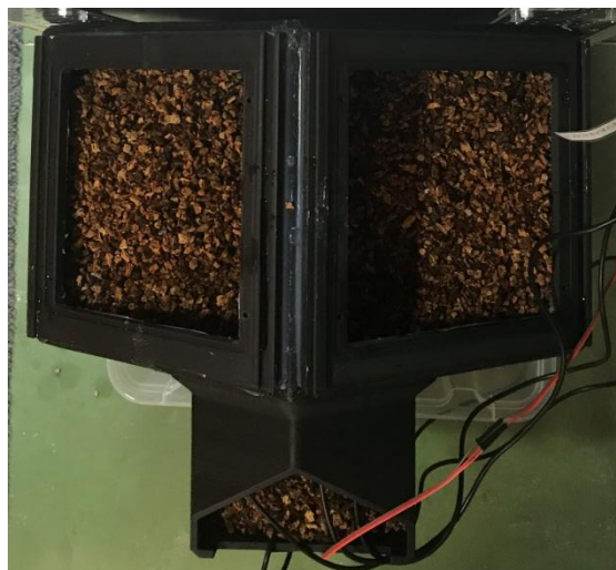
Figura 24: Mòdul ple del suro utilitzat. Font: Pròpia
