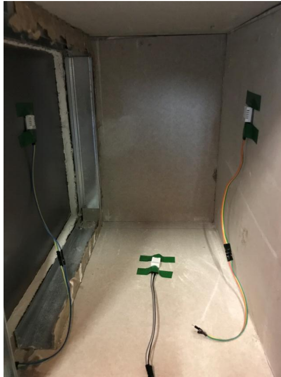
Figura 79: Imatge situació dels sensors a l'interior de la caixa de mesures. Font: Pròpia
