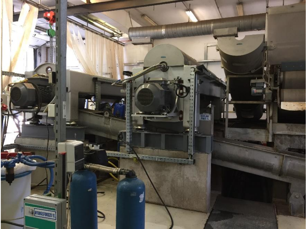
Ábra 7.4: Centrifugaállomás a szennyvíziszap víztelenítéséhez, Nyíregyháza
