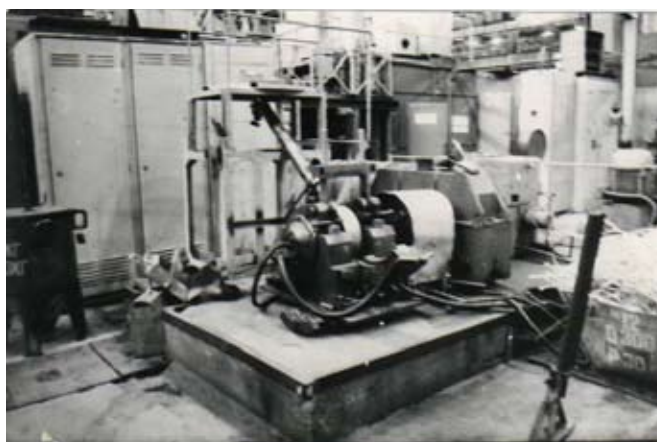
Рис. 2. Установка Конформ на участке по изготовлению прутков из гранулированных алюминиевых сплавов
