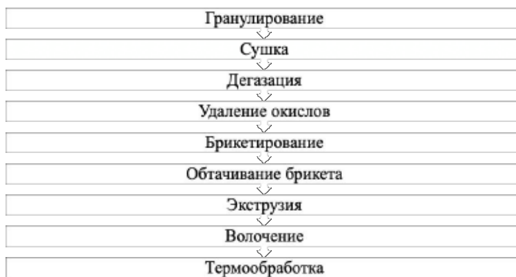
Рис. 1. Технологическая схема получения проволоки из гранул
