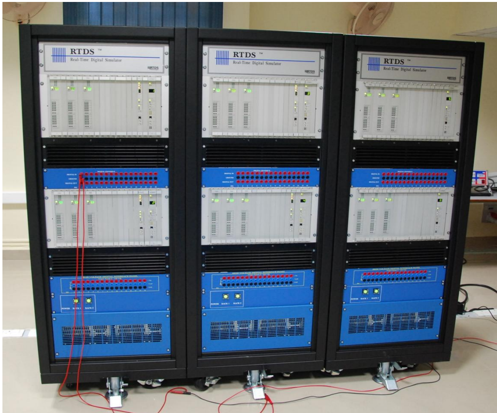
Εικόνα 2. 1 Ψηφιακός προσομοιωτής πραγματικού χρόνου (RTDS) [10]
