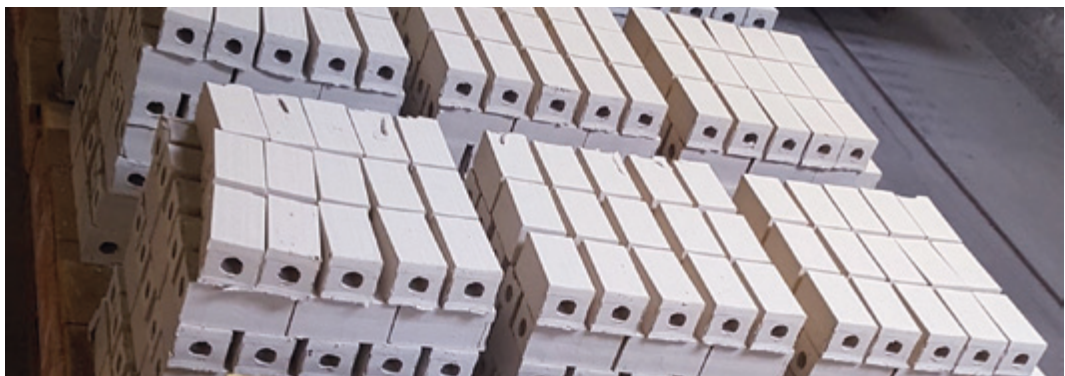
Abb. 12.2: Gepresste Batzen zum Schamottebrand (Quelle: KTS).
