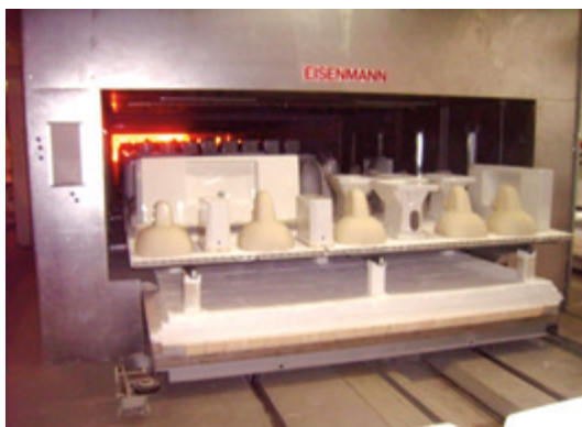
Abb. 12.1: Tunnelofen zum Brand von Sanitärkeramik (links, Quelle: Eisenmann) und Herdwagenofen mit seitlicher Gasbefeuerng (rechts, Quelle: Rath).
