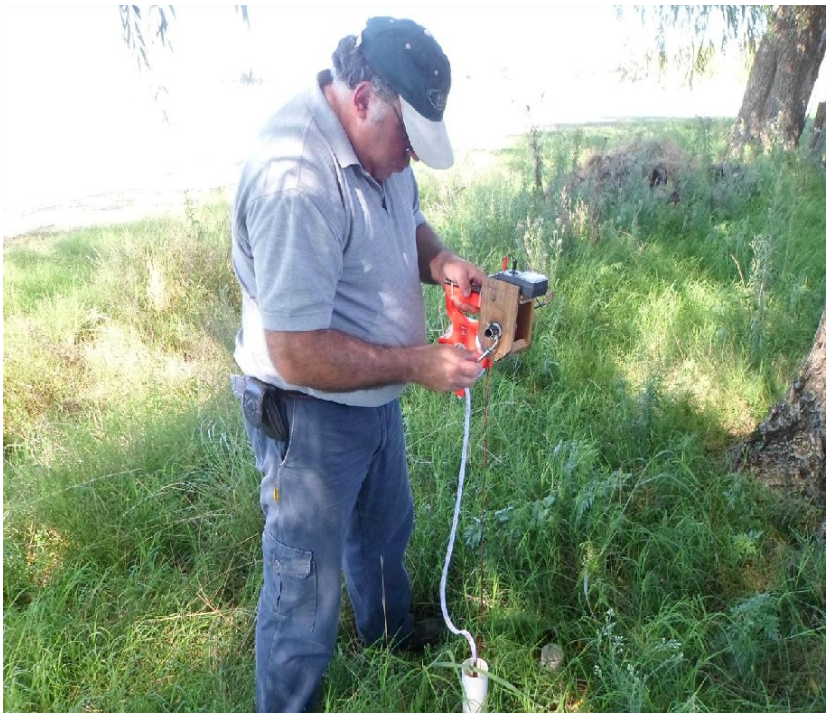
Figura III.d. Sonda para la medición de la profundidad freática
