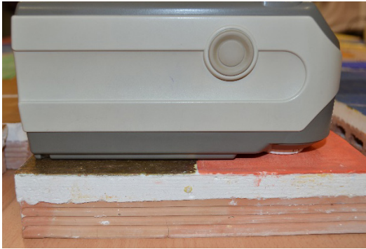
Fig. 5. Medición efectuada sobre uno de los acabados policromos de las probetas de yeso antes del ciclo de envejecimiento.
