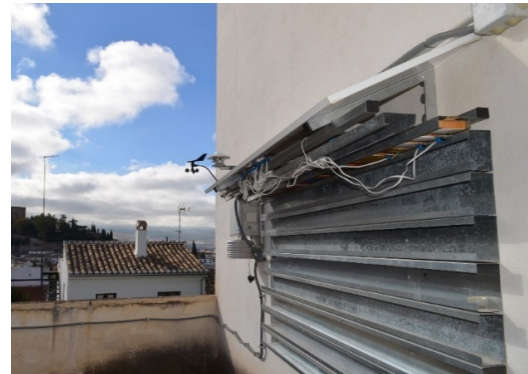
Figura 7- Imagen de las probetas de madera colocadas para su envejecimiento exterior. Como se puede observar, en ambos casos se sitúan reproduciendo las características de su situación en obra real.
