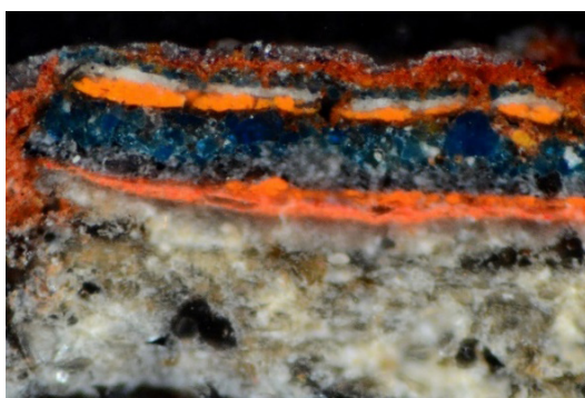
Figura 8- Superior izqda. Diferentes estratos que componen una muestra tomada de la zona del friso con decoración epigráfica donde se aprecia sucesiva intervenciones a lo largo su historia. Microscopio óptico con luz reflejada.
