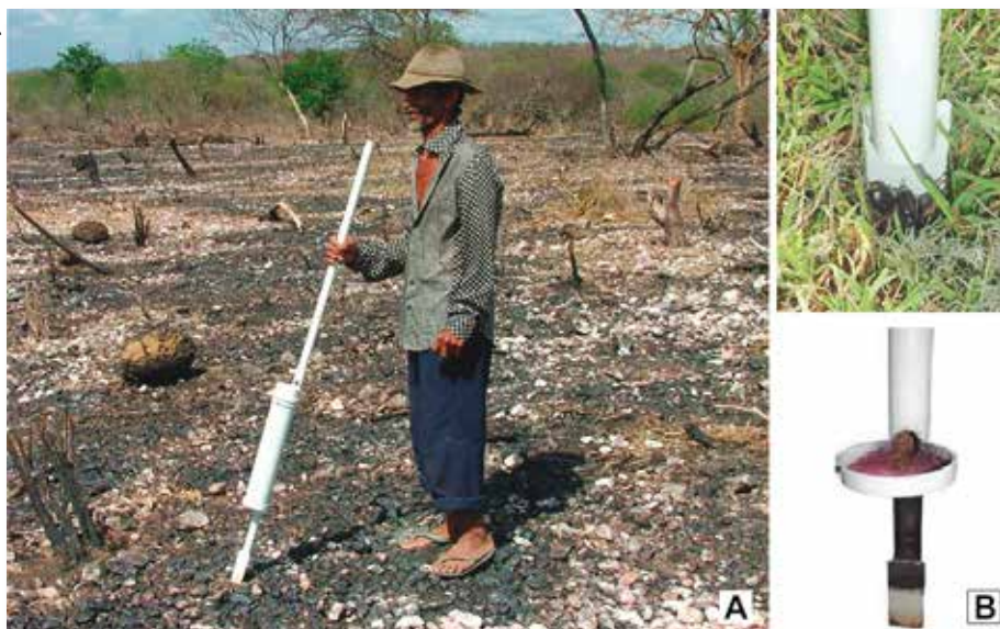
Figura 2. Semeadora manual (A) e detalhe de distribuidor de semente (B) utilizados para semeadura direta.
