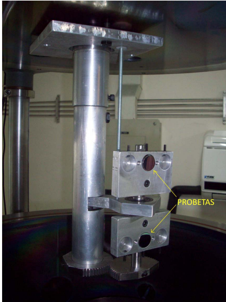
Figura 6.10. Fotografía del dispositivo construido y ubicado al interior de la cámara de vacío en el equipo magnetron sputtering.
