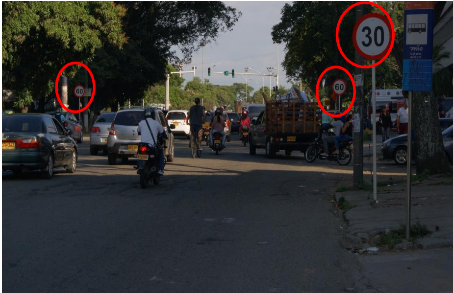
Figura 16. Señal de límite de velocidad de 30 km y otra a menos de 40 metros indicando límite de velocidad de 60km
