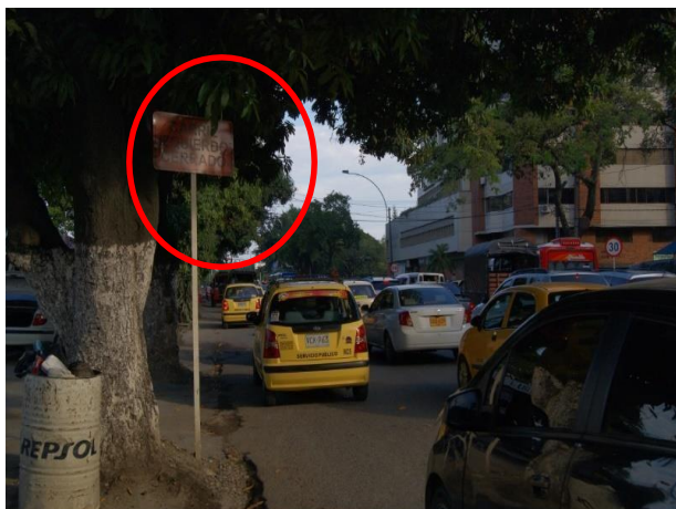
Figura 18. La señal esta tapada ramas y además está indicando una situación que no es consecuente con lo que pasa en la vía
