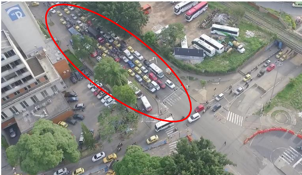
Figura 12. La transición para incorporarse al enlace para el giro es muy corta y permite el entrecruzamiento de vehículos. Generación de altas congestiones
