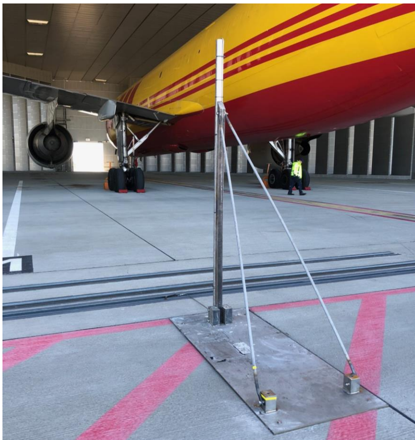
Abb. 6 Probenahmesonde in Position am Triebwerksprobelaufstand
