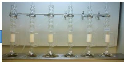
Armar el equipo de extracción. Iniciar la extracción 8 horas, revisar que el nivel de solvente.
