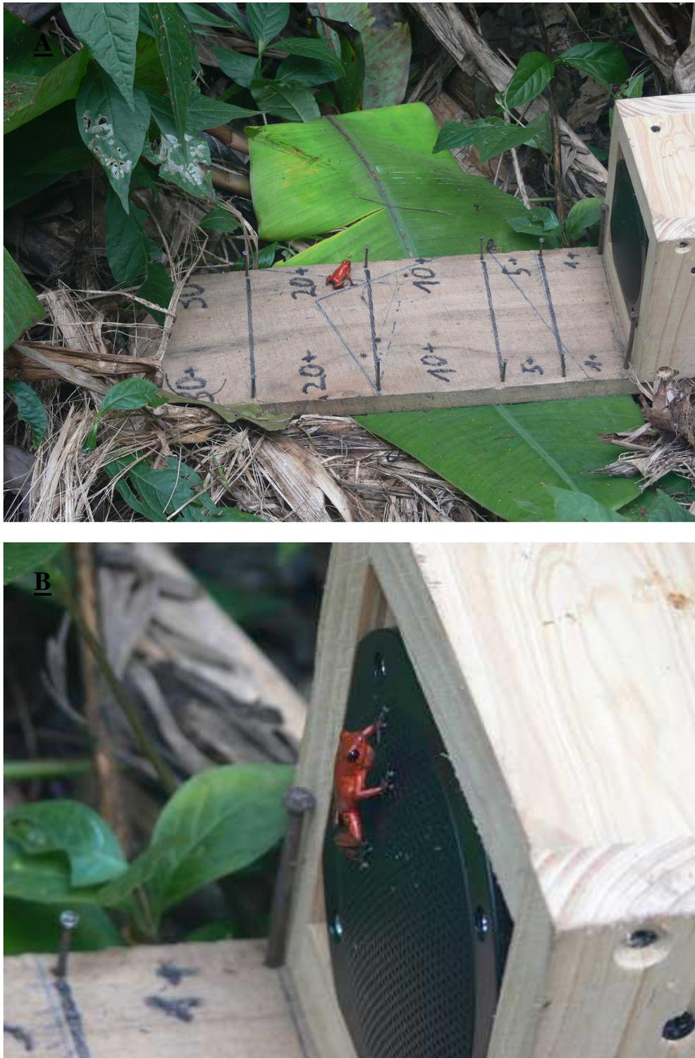
Abb. 2. A) Holzkonstruktion für die Durchführung der Playbackexperimente. Der Abstand zwischen dem Lautsprecher und dem Männchen zu Beginn der Experimente betrug 75cm. Der Abstand zwischen dem Lautsprecher und dem Ende des Brettes betrug 37,5cm. Die Markierungen auf dem Brett geben die Distanz zum Lautsprecher wieder. B) eine während der Playbackexperimente häufig zu beobachtende Verhaltensweise: Das Testmännchen nähert sich rufend der Schallquelle und springt diese schließlich an.
