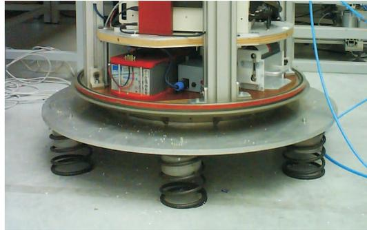
Abbildung 5.3: Experimentaufbau auf der Sprungplattform. Zu sehen ist der untere Teil der auf der Plattform befestigten Experimentierkapsel
