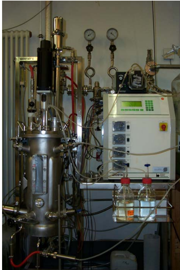
Abbildung 11.2: Bioreaktorsystem Biostat C (Kessel und Steuereinheit).
