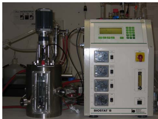
Abbildung 11.1: Bioreaktorsystem Biostat B (Kessel und Steuereinheit).
