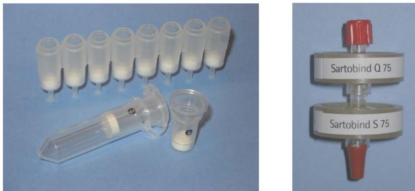
Abbildung 3.1 Links: *Vivapure spin columns* und *8-strip*. Rechts: *Sartobind MA units*.
