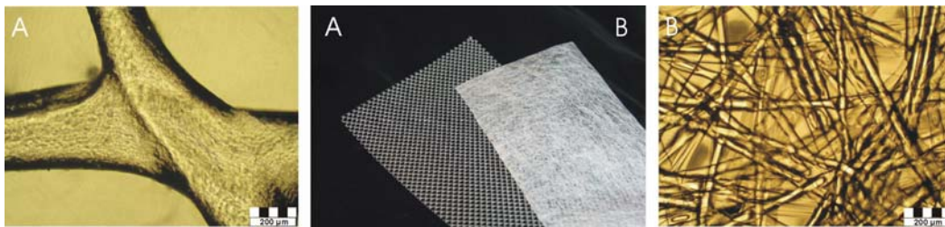
Abbildung 4.4.17: Struktur des Netz- und Vlies-Spacer. Mikroskopische Aufnahme bei 100-facher Vergrößerung.
