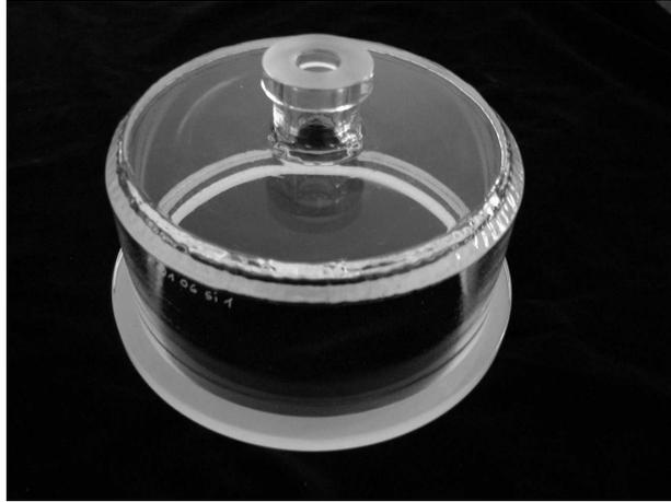
**Abb. 2.6:** Die Abbildung zeigt den Quellenkörper aus GE124 Material vor der Benutzung. Die Wandstärke beträgt 9 mm. Der Innendurchmesser 150 mm. Die opaken Flächen sind geschliffene Dichtflächen.
