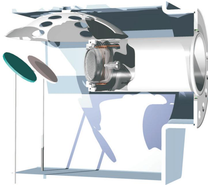
**Abb. 2.4:** Schnittansicht der BAK Beschichtungsanlage mit eingebauter Sputterquelle.
