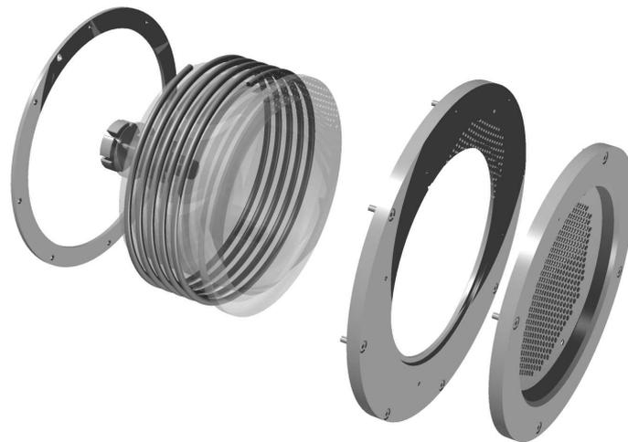
**Abb. 2.11:** Illustriert ist eine technische Explosionsgrafik: der Hauptflansch (mitte), der Ionisator linksseitig und das Gitterextraktionssystem rechts.
