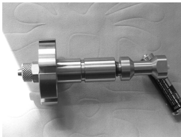
**Abb. 2.8:** Dargestellt ist der LZH RIM Gaseinlass im Größenverhältnis mit einer Standard AAA Batterie. Zu erkennen sind Gasanschlussverschraubung, Kühlrippen und Dichtnut. Das Keramikrohr ist im verschraubbaren Kopfteil mit hochtemperaturfestem Klebstoff abgedichtet. Die HV-Kontaktierung ist linksseitig an den Kühlrippen.
