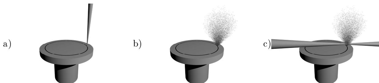
Abbildung 4.23: Rotierendes *Target*. a) Der Ablationslaser trifft die rotierende Lithiumscheibe von oben. b) Eine Wolke Lithiumteilchen wird nach oben weg geschleudert. Eine Vertiefung bleibt zurück. c) Die Teilchen werden von einem von links kommenden Laserpuls angeregt.
