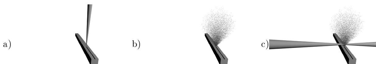
Abbildung 4.24: Lineartarget. a) Der Ablationslaser trifft den Lithiumstreifen von oben. b) Eine Wolke Lithiumteilchen wird nach oben weg geschleudert. Eine Vertiefung bleibt zurück. c) Die Teilchen werden von einem von links kommenden Laserpuls angeregt. Das Lineartarget wird verschoben (auf den Betrachter zu).
