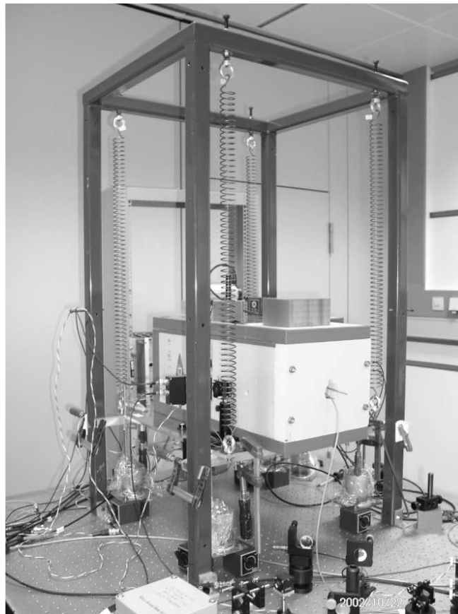
Abbildung 2.26: Vibrationsisolierende Federaufhängung von Resonator 1 . Referenzresonator, Vakuumkammer und die Optik zur Modenanpassung befinden sich in der Box aus Hartschaumstoff. Der gesamte Aufbau wird von einer akustikisolierenden Box umschlossen (auf dem Foto noch nicht installiert).
